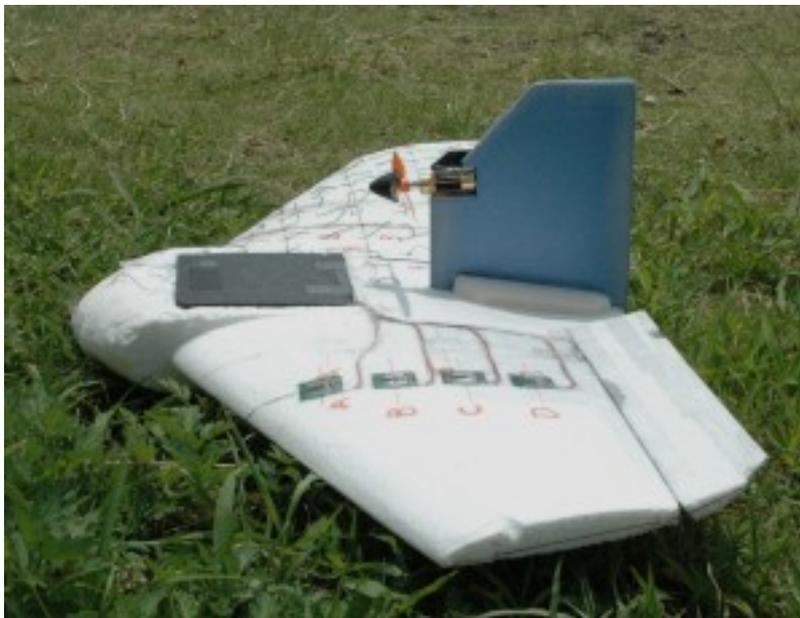
MEMS Flow センサ，レートジャイロ，マイコンなどを実装した飛行試験モデル
